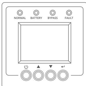
Рис.5-1 Жидкокристаллическая панель
